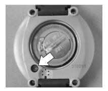
Figure 23. System Reset Button
